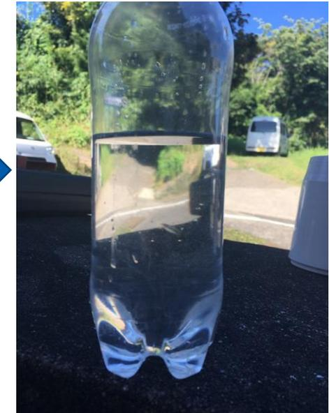
半年量を (55,000L) 通水した膜に高濁度原水を通水しても処理水濁度 0 度
